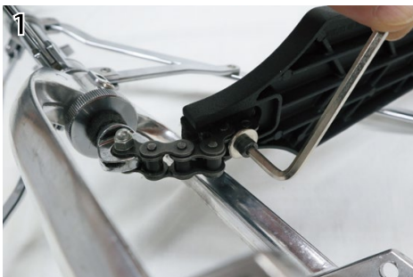
1 CHS-1 付属のレンチでチェーンネジを外します。
